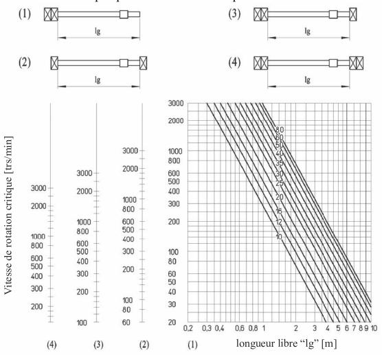
Exemple: trouver la Vitesse critique d'une vis Tr 40x7 long. 3000 mm en contrainte selon la figure  $N^{\circ}$  3 avec une installation de précision moyenne.
