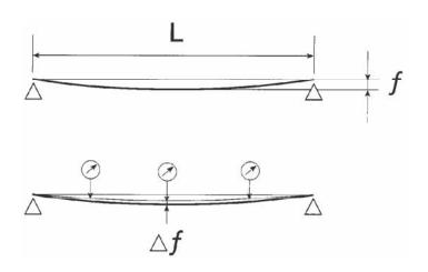
f = flèche due au poids propre de la vis pour une vis de Tr 30x6 avec L = 3.000 mm  $\Delta f$  maximale: 0,3 mm
