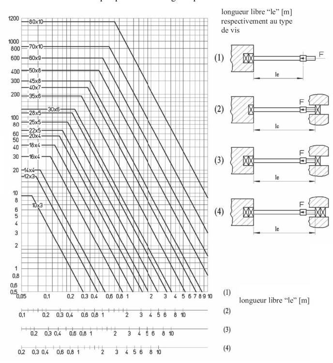
Exemple: trouver la charge axiale admissible d'une vis Tr 30x6 long. 3000 mm en condition de contraintes indiquée par la figure  $N^{\circ}$  4. Par le graphique  $N^{\circ}$  6 on a Fmax = 11 kN; avec un coefficient de sûreté = 2 on peut obtenir Famm = 11/2 = 5,5 kN
