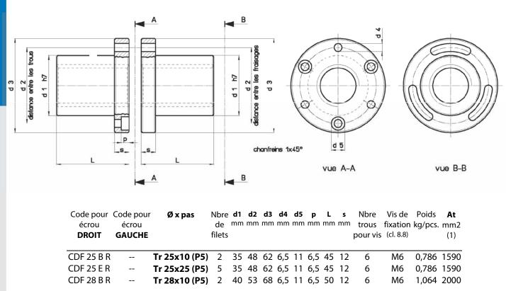
(1) Surface d'appui totale entre les dents de la vis et les dents de l'écrou sur le plan perpendiculaire à l'axe.
